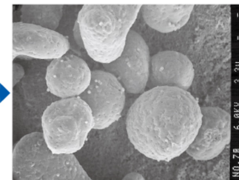
原料：母粒子=トナー+子粒子=アクリル微粒子 平均粒子径Dp50=10.0μm Encapsulated toner by PMMA D 50 =10μm
